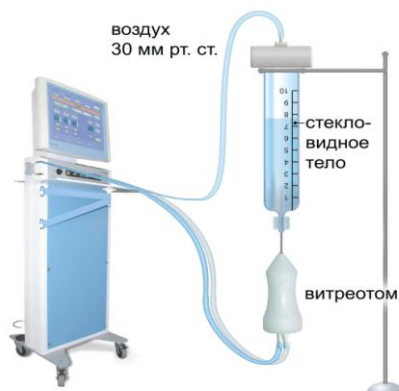
Рисунок 1 - Схема тестового стенда для исследования производительности системы для витрэктомии.
