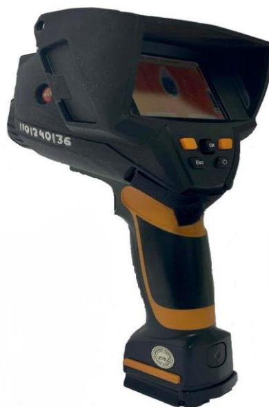
Рис. 1. Инфракрасный тепловизор «Testo 875»
