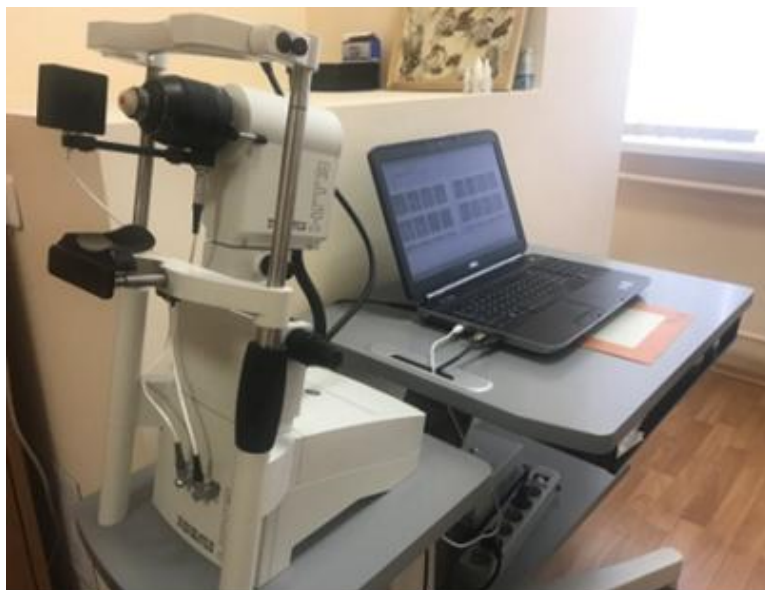
Рисунок 46. Внешний вид лазерного конфокального микроскопа роговицы с использованием специальной насадки для роговицы.
