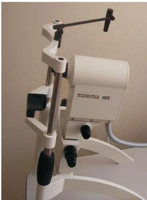
*Рисунок 4. Внешний вид лазерного конфокального микроскопа HRT III с роговичным модулем Cornea Rostock. Heidelberg Engineering.*
