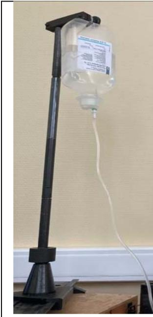
Рис. 19 Закрепление емкости с раствором на специальной конструкции с возможностью изменения уровня водного столба.
