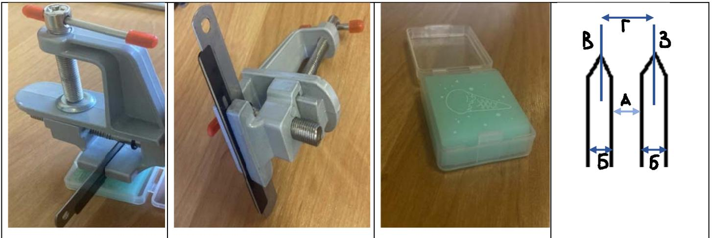
Рис. 21 Установка для выделения экспериментальных образцов роговицы (с объяснением получения иссеченного образца необходимого размера)
