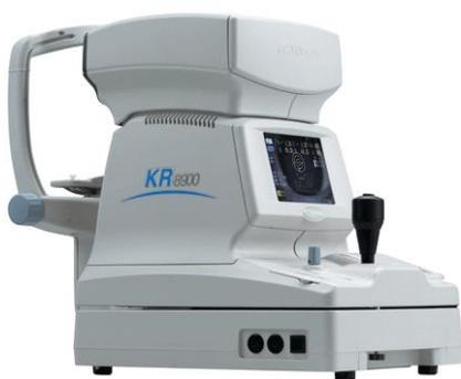
Рисунок 1. Авторефрактометр фирмы Topcon KR-8900 (Япония).
