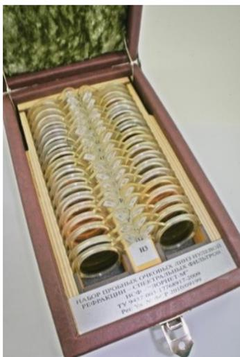
Рисунок 7. Набор спектральных фильтров НСФ- «Лорнет-М» (Россия)
